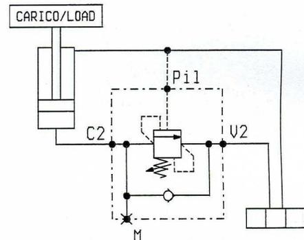
Pressione max 350 bar / Max pressure 350 bar
