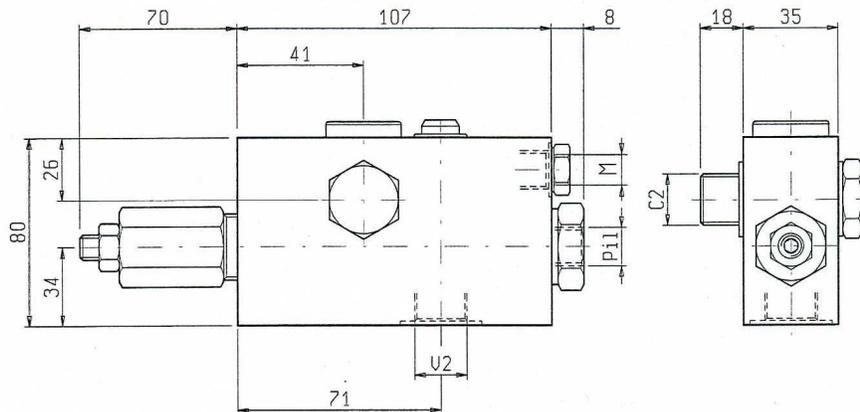
La serie "NBA" ha la sede di tenuta dell'unidirezionale in acciaio per una maggiore affidabilità. E' possibile variare il rapporto di pilotaggio con semplicità. Controllo eccellente in un ampio campo di portate/pressioni. La flangiatura diretta garantisce la massima sicurezza, minime perdite di carico, compattezza d'installazione e costi contenuti. -Con perdita trascurabile.
